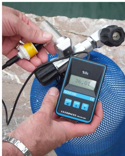
**L'ANALYSE NE DOIT SE FAIRE QUE SI LE MÉLANGE EST PARFAITEMENT HOMOGÉNÉISÉ. IL EST CONSEILLÉ D'ATTENDRE QUELQUES HEURES APRÈS LA FABRICATION.**
