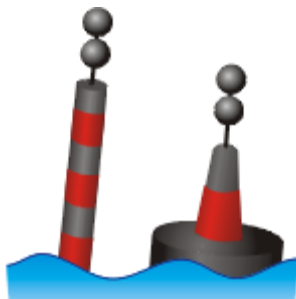
Danger isolé (S'écarter du danger)
